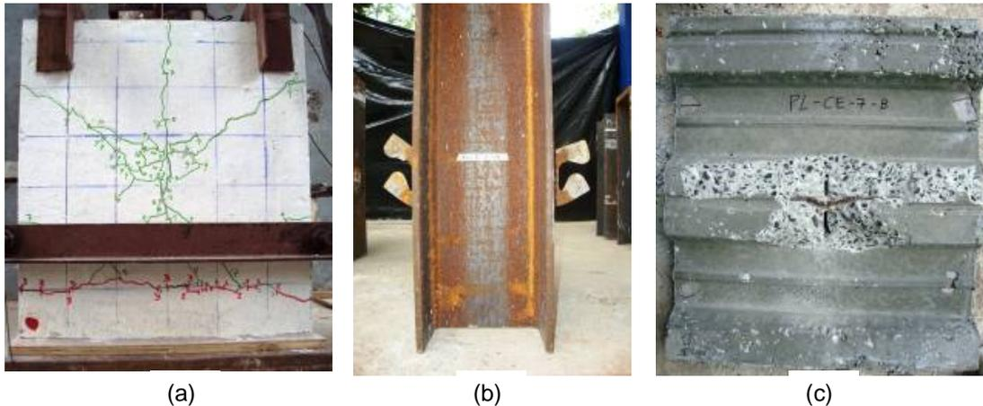
**Figura 13.** Especimen con conector tipo P en losa con lámina, (a) Patrón de daños. (b) Conector después del ensayo, (c) Cara interior de la losa luego del ensayo.
